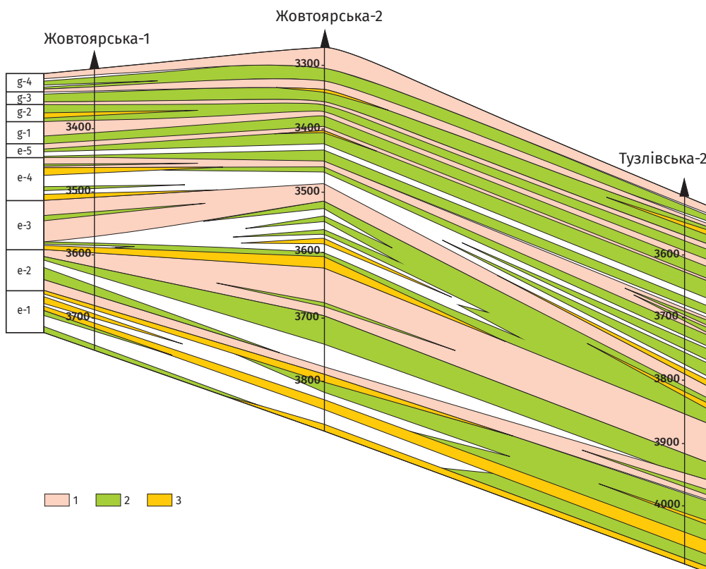
Рис. 6. Літофізична структура відкладів середнього девону: 1 – флюїдоупори; колектори: 2 – порові, 3 – тріщинні
