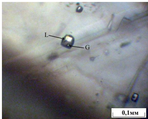
Рис. 3. Первинне газово-рідке включення форми негативного кристалу у кальциті. Температура гомогенізації складає 70 \pm 5 °C. Заболотівська світа. Св. 5843. Глибина відбору становить 338,0 м
