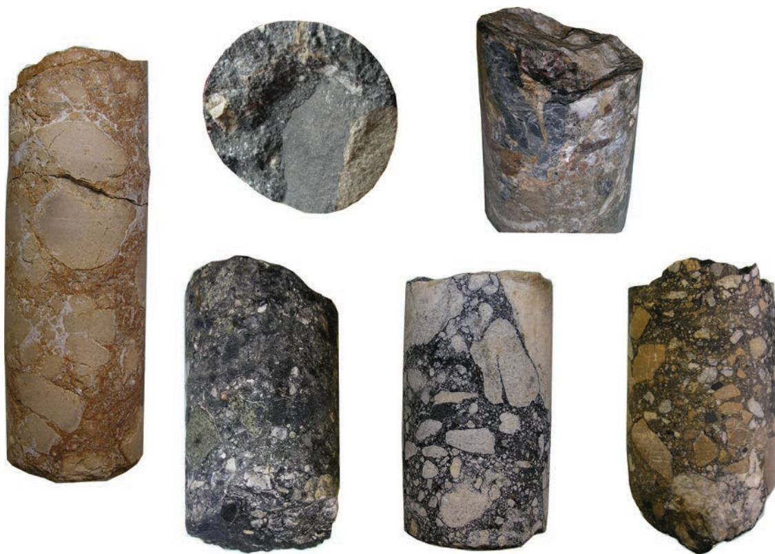
Рис. 3. Образцы придиапировых брекчий (кern из скважин глубокого бурения) Skorobogatky-Pesochansky солянокупольной структуры
